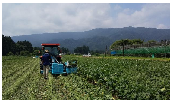
トラクターアタッチメント式のえだまめ収穫機
