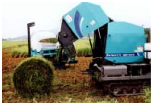
専用機械による収穫梱包とラッピング作業。
